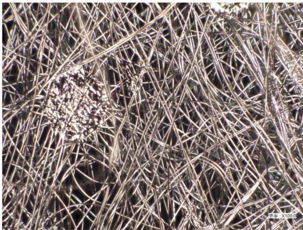
図 1. 銅合金蒸着不織布の表面 (倍率 100 倍)
